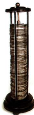
△ PILA VOLTAICĂ ESTE ALCĂTUITĂ DINTR-O SERIE DE DISCURI DE FIER ȘI ZINC ALTERNATE CU BUCĂȚI DE MATERIAL TEXTIL IMPREGNATE CU O SOLUȚIE SALINĂ.
